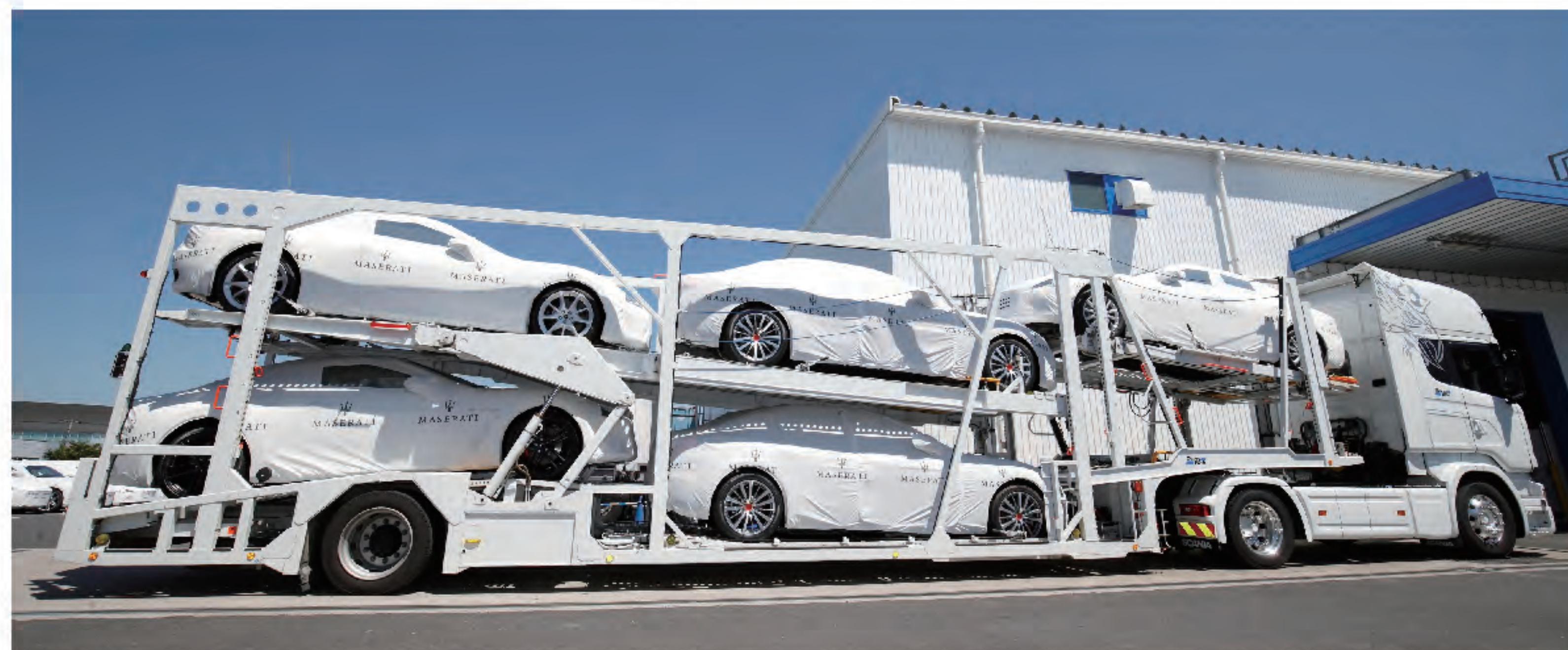
弊社の最新型キャリアカー。トランスポーター同様、白でコーディネートされ、フルサイズの乗用車5台を搭載可能な仕様です。
