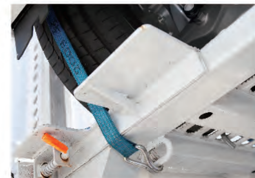
車両の固定は繊維製のタイヤップベルトで確実にいきます。
