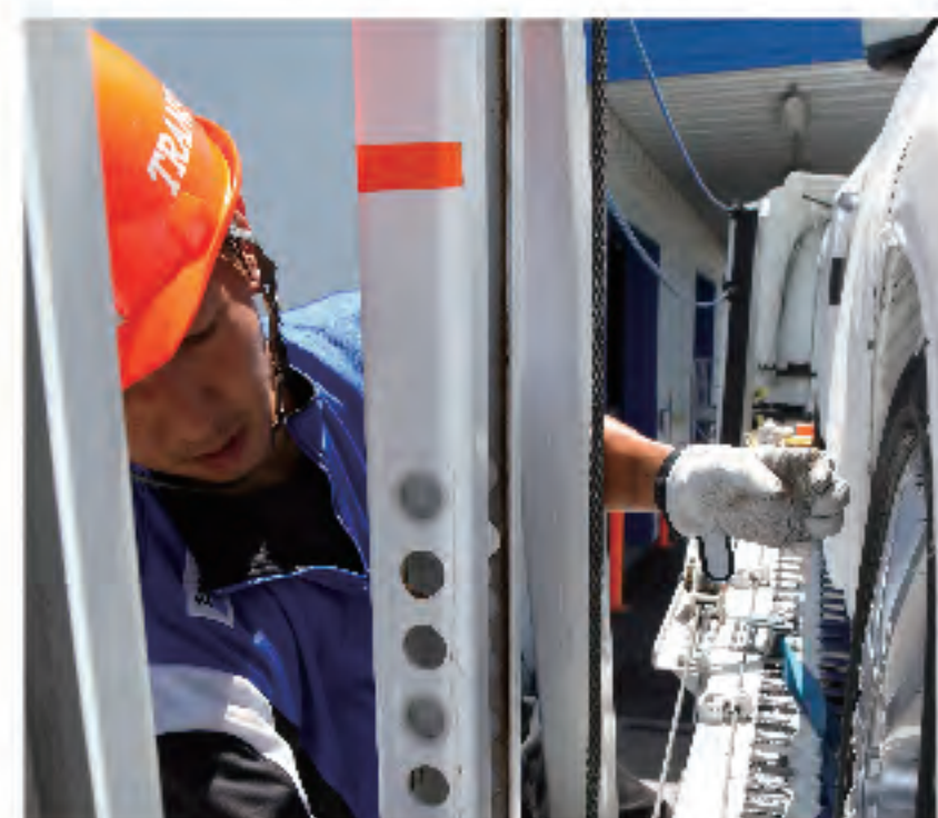
弊社では危険箇所の認知を徹底させるため、危険箇所はオレンジカラーで着色しています。
