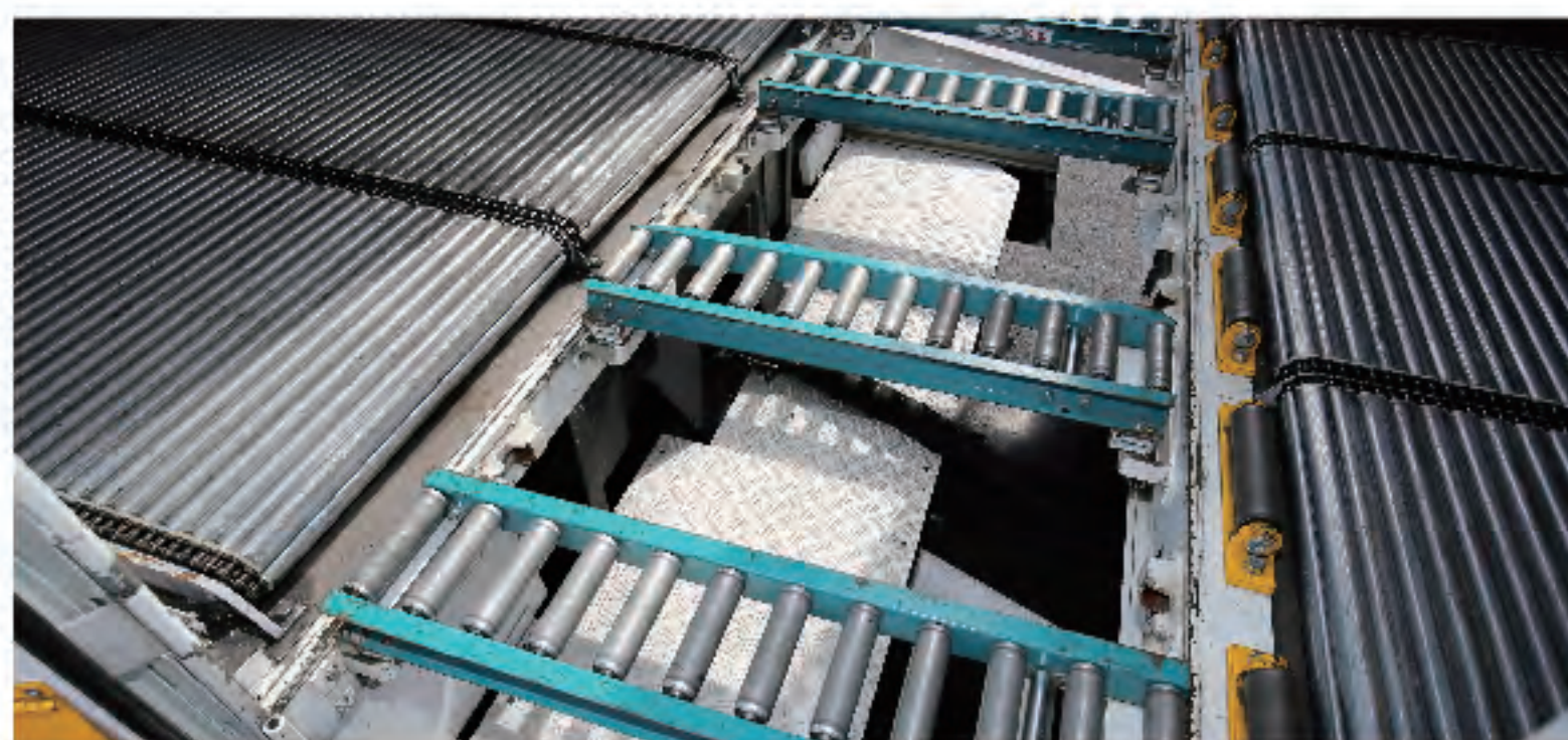
トレーラーをつなぐローラーにより前の荷室にも最後尾から積載可能です。
